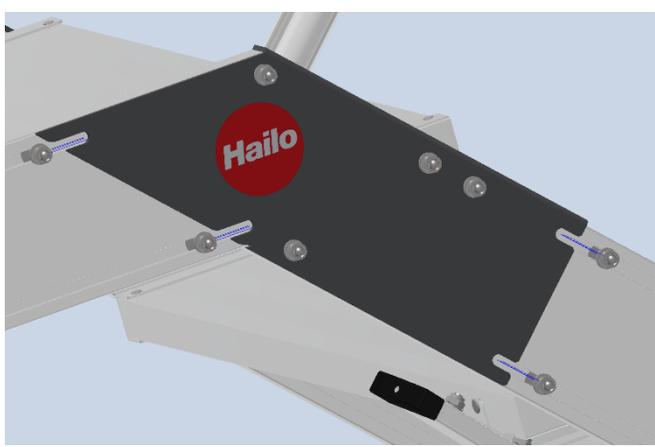
**Befestigung der Geländerteile an der Treppe sowie am Podest – Verschraubung M8**
