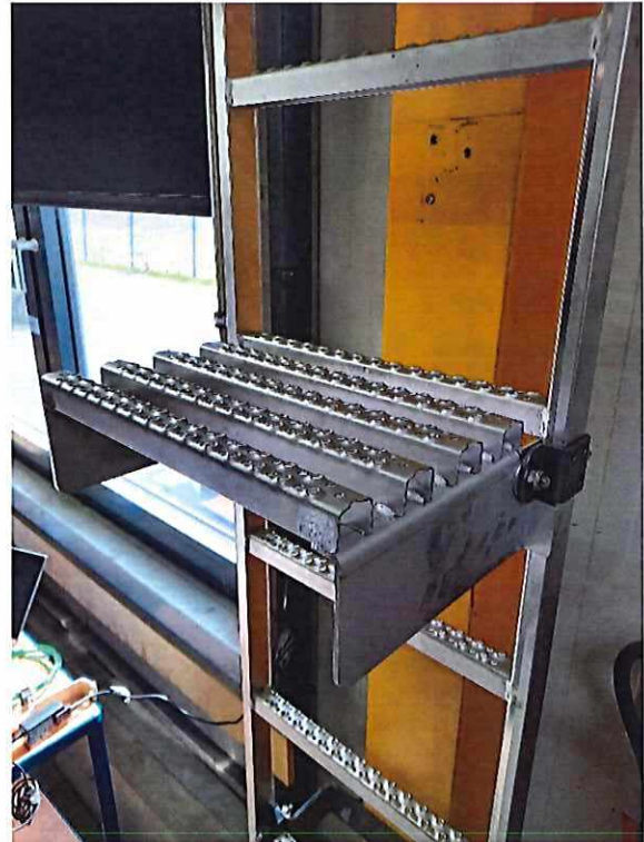
Abbildung 2: Austrittsverlängerung (Ausführung 330 mm, aus Prüfungsgründen an Leitervorderseite montiert)
