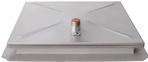
Mittig überhöhter Deckel mit Verstärkungssicken und verdeckt liegenden Scharnieren, Gasdruckfeder, umlaufende Dichtung, selbst einfallende Feststelleinrichtung und Schließeinrichtung. Der Rahmen besteht aus Winkelprofil mit innenliegenden Dübellaschen. Weitere Größen auf Anfrage.
