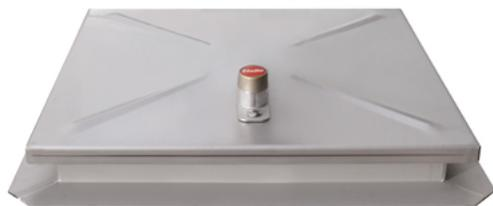
Le couvercle est surélevé en son milieu, avec bourrelets de renforcement et charnières invisibles, vérin à gaz, joint d'étanchéité périphérique, dispositif de blocage automatique et dispositif de fermeture Le cadre a en profilé angulaire avec colliers intérieurs de fixation par chevilles. Autres dimensions sur demande
