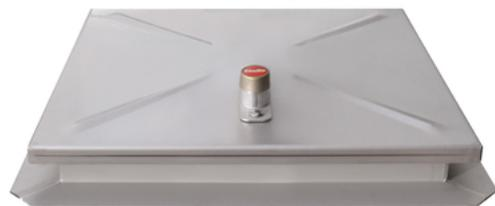
Mittig überhöhter Deckel mit Verstärkungssicken und verdeckt liegenden Scharnieren, Gasdruckfeder, umlaufende Dichtung, selbst einfallende Feststelleinrichtung und Schließeinrichtung. Der Rahmen besteht aus Winkelprofil mit innenliegenden Dübellaschen. Weitere Größen auf Anfrage.
