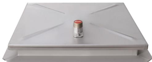
Mittig überhöhter Deckel mit Verstärkungssicken, verdeckt liegenden Scharnieren, Gasdruckfeder als Öffnungshilfe, selbstwirkendem Feststeller und selbsteinfallender Verschluss mit Notenriegelung, von unten zu öffnen. Der Rahmen besteht aus einem Winkelprofil mit umlaufender frost- und witterungsbeständiger, sowie insektensicherer Dichtung und innenliegenden Dübellaschen (Befestigungsmaterial separat unter Zubehör erhältlich). Weitere Größen auf Anfrage.
