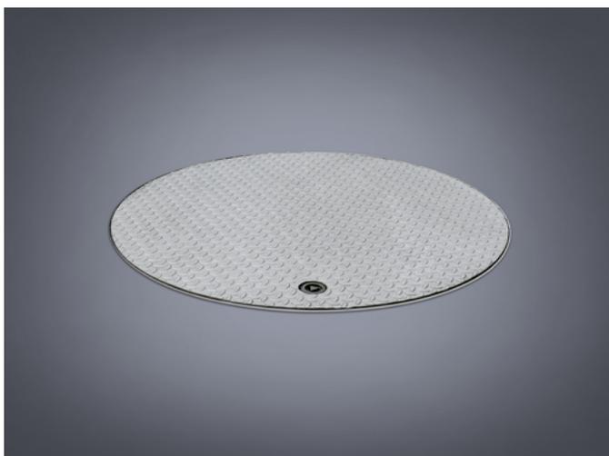
HS8-R anti-effraction (RC3 - DIN 1627) en acier inoxydable 1.4301 / AISI 304 classe de charge B/D - EN124
